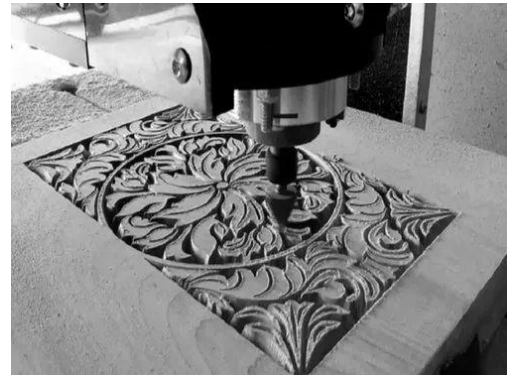
CNC- Computer Numerical Control (কম্পিউটার-সংখ্যাগতভাবে-নিয়ন্ত্রিত কাটিং)
